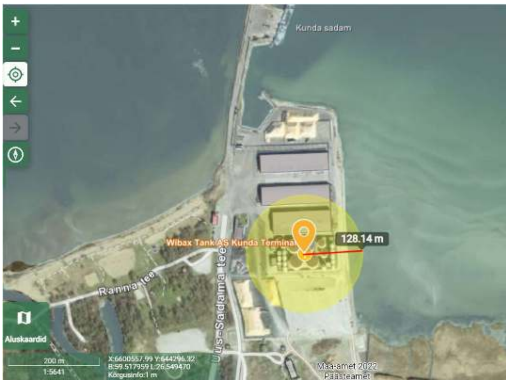
Joonis 1. Vallialade põlengu ohualad ehitistele: 59 m ja inimelule 128 m.
